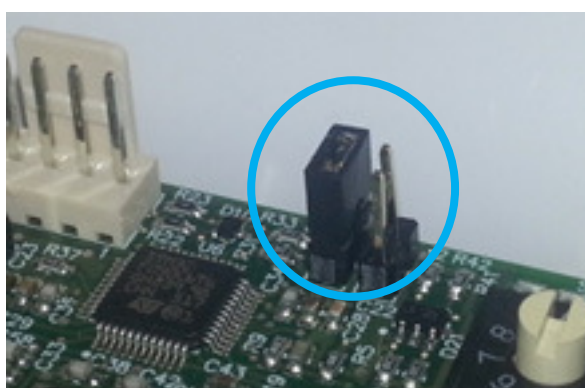
Figura 36:Jumper de la entrada de control remoto.
