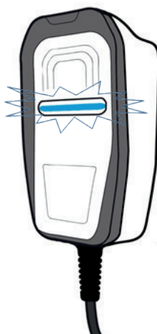
Figura 40: La estación de carga no dispone de suficiente corriente.
